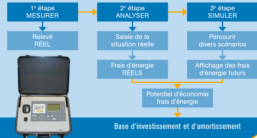
EBS - Le système établissant le bilan d'énergie
